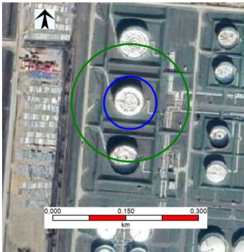
6.3.5.3.4.1.1. ábra C2 eseménysor Gőztűz - hőszugárzás
