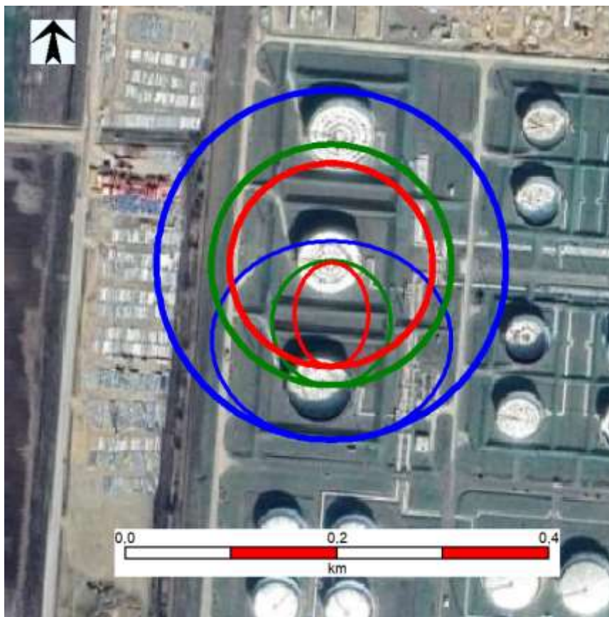
6.3.5.3.4.1.2. ábra C2 - Jettűz - hőszugárzás
