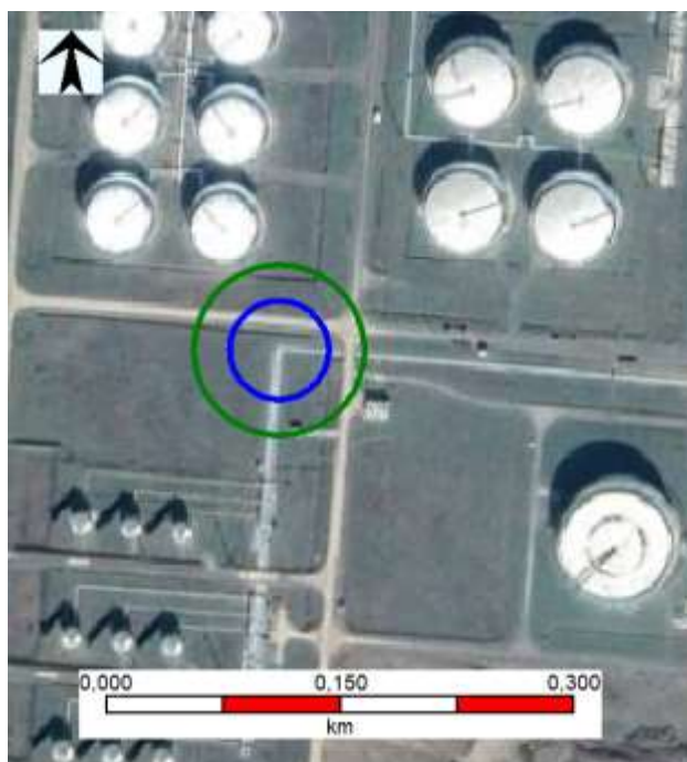
6.3.5.5.2.1.1. ábra E1 eseménysor Gőztűz - hőszugárzás
