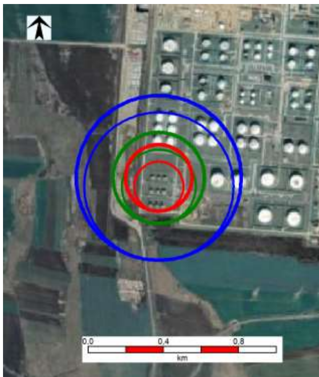
6.3.5.1.4.1.4. ábra A2 – Azonnali tócsatűz – hőszugárzás
