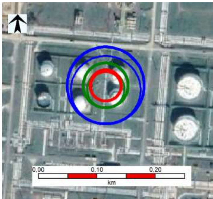
6.3.5.9.2.1.3. ábra I1 – Azonnali tócsatűz – hőszugárzás
