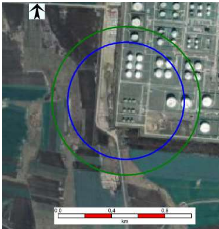
6.3.5.2.4.1.4. ábra B2 eseménysor Gőztűz - hőszugárzás
