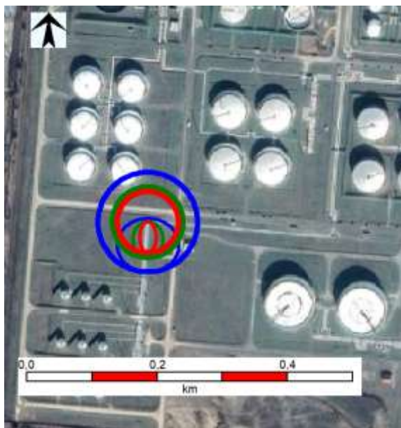
6.3.5.5.2.1.2. ábra E1 - Jettűz - hőszugárzás
