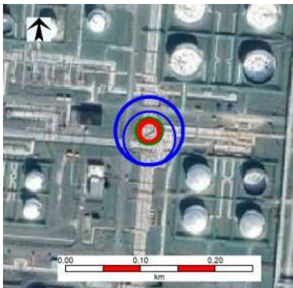
6.3.5.8.3.1.3. ábra H2 – Azonnali tócsatűz – hőszugárzás
