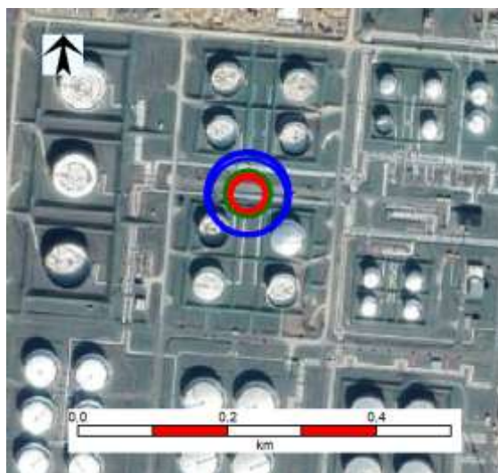
6.3.5.7.2.1.3. ábra G1 – Azonnali tócsatűz – hőszugárzás
