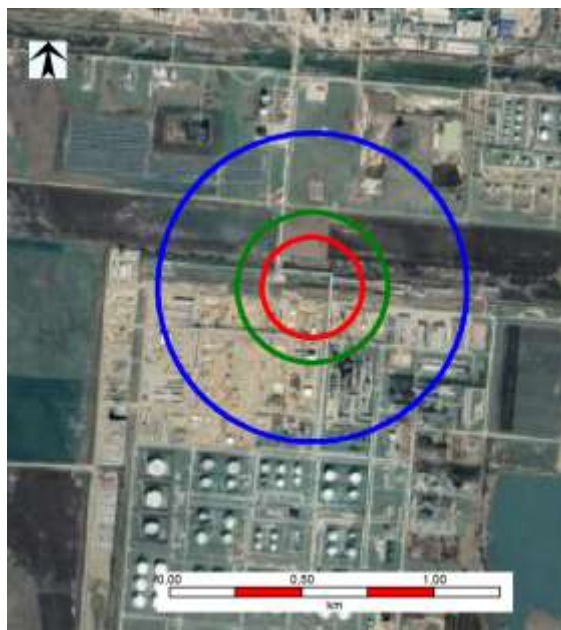
6.3.5.11.3.1.1. ábra K1 eseménysor Tűzgolyó - hőszugárzás
