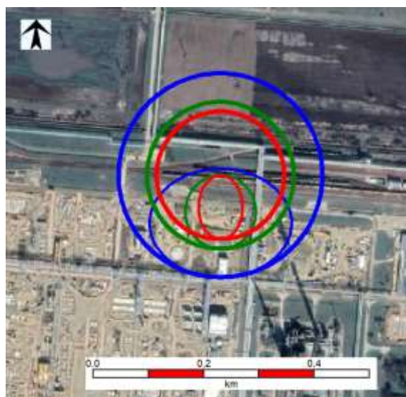
6.3.5.11.3.1.4. ábra K2 - Jéttűz - hőszugárzás
