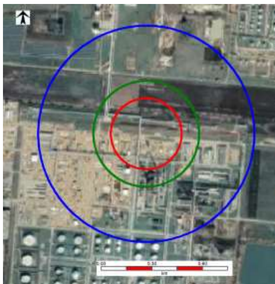
6.3.5.10.3.1.1. ábra J1 eseménysor Tűzgolyó - hőszugárzás
