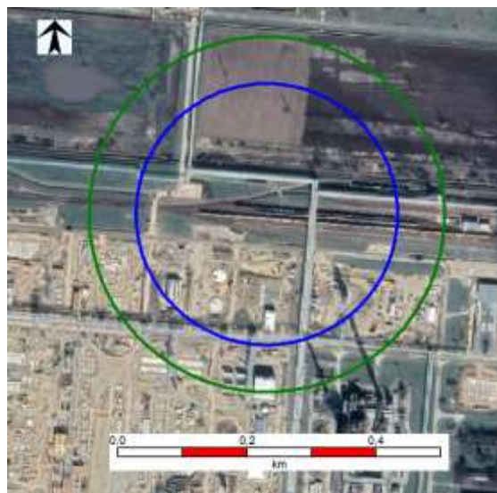
6.3.5.11.3.1.3. ábra K2 eseménysor Gőztűz - hőszugárzás
