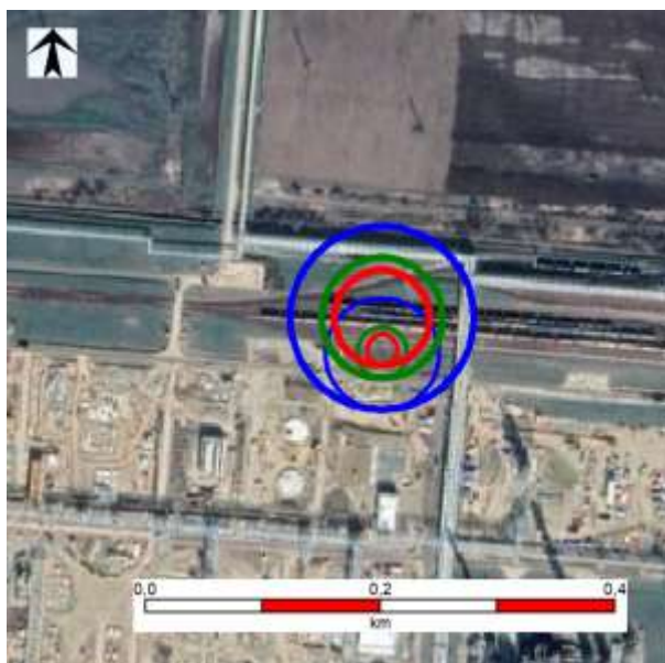
6.3.5.11.3.1.5. ábra K2 – Azonnali tócsatűz – hőszugárzás
