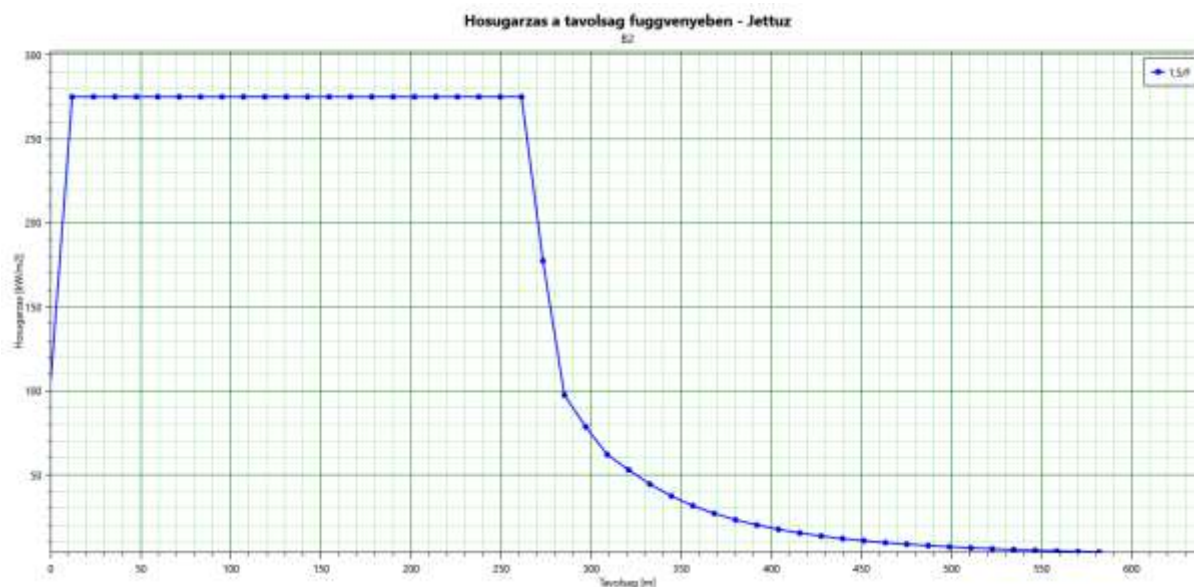
B2.1. ábra TIT_B2_Jet (Hőszugárzás vs. távolság)
