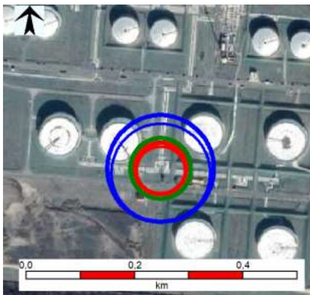
6.3.5.6.2.1.3. ábra F1 – Azonnali tócsatűz – hőszugárzás
