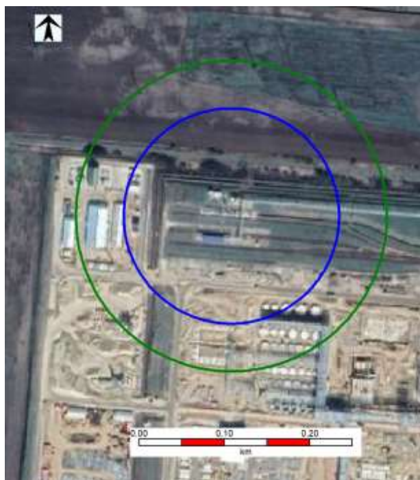
6.3.5.12.5.1.2. ábra L1 eseménysor Gőztűz - hőszugárzás
