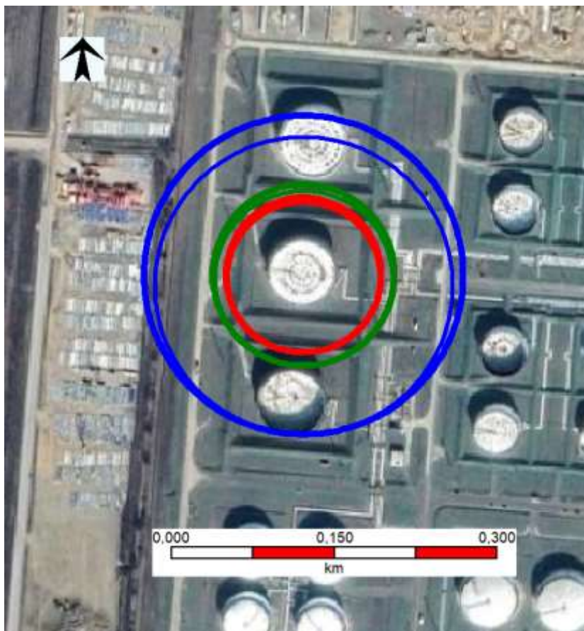
6.3.5.3.4.1.3. ábra C2 – Azonnali tócsatűz – hőszugárzás
