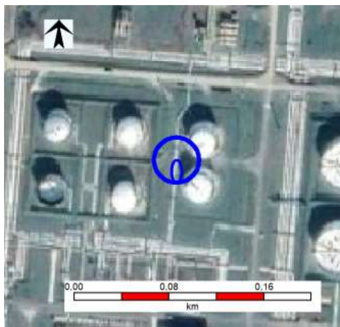
6.3.5.9.2.1.2. ábra I1 - Jettűz - hőszugárzás
