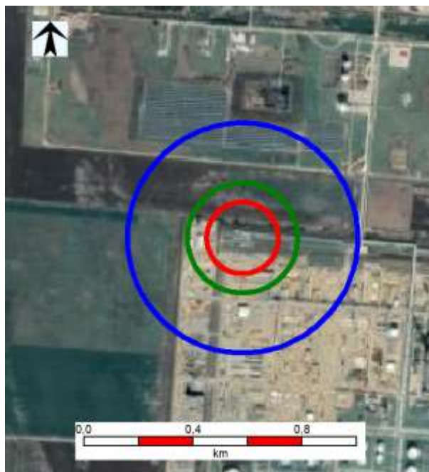
6.3.5.12.5.1.1. ábra L1 eseménysor Tűzgolyó - hőszugárzás
