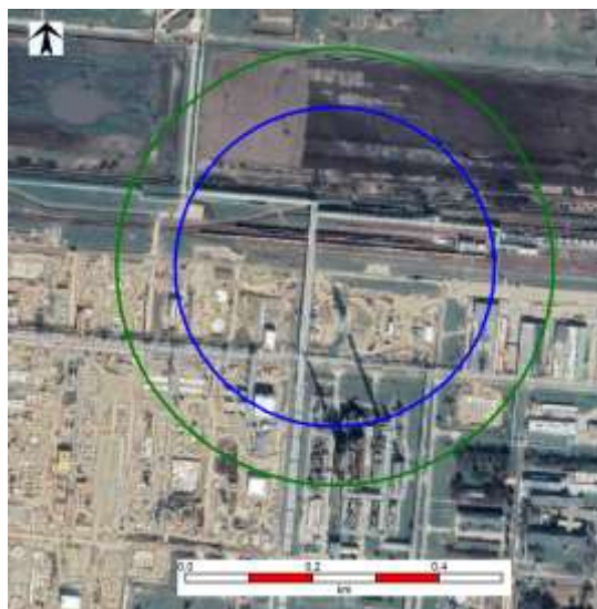
6.3.5.10.3.1.3. ábra J2 eseménysor Gőztűz - hőszugárzás
