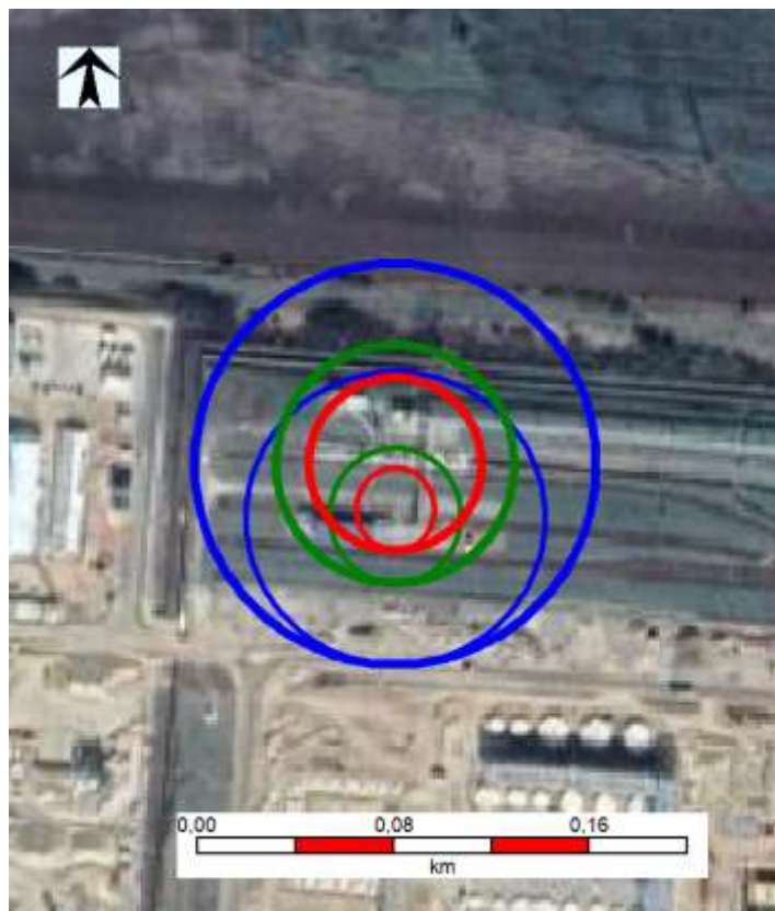
6.3.5.12.5.1.6. ábra L2 – Azonnali tócsatűz – hőszugárzás
