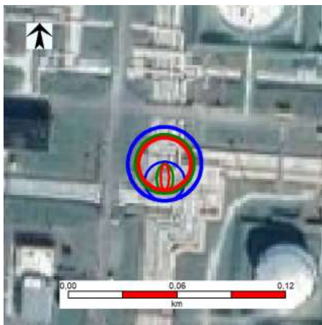
6.3.5.8.3.1.2. ábra H2 - Jettűz - hőszugárzás
