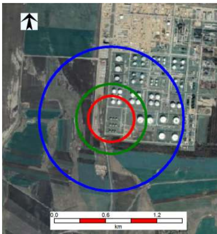
6.3.5.2.4.1.1. ábra B1 eseménysor Tűzgolyó - hőszugárzás
