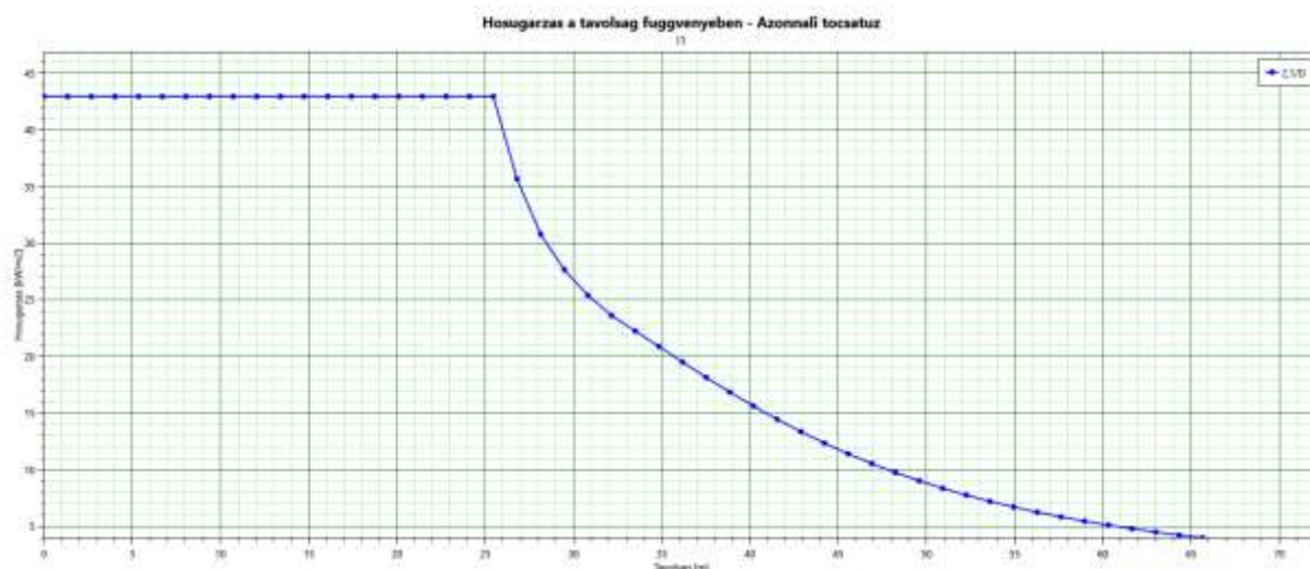
I1.2. ábra: TIT_I1_Jet+ATócsa (Hőszugárzás vs. távolság – Azonnali tócsatűz)
