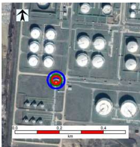
6.3.5.5.2.1.3. ábra E1 – Azonnali tócsatűz – hőszugárzás
