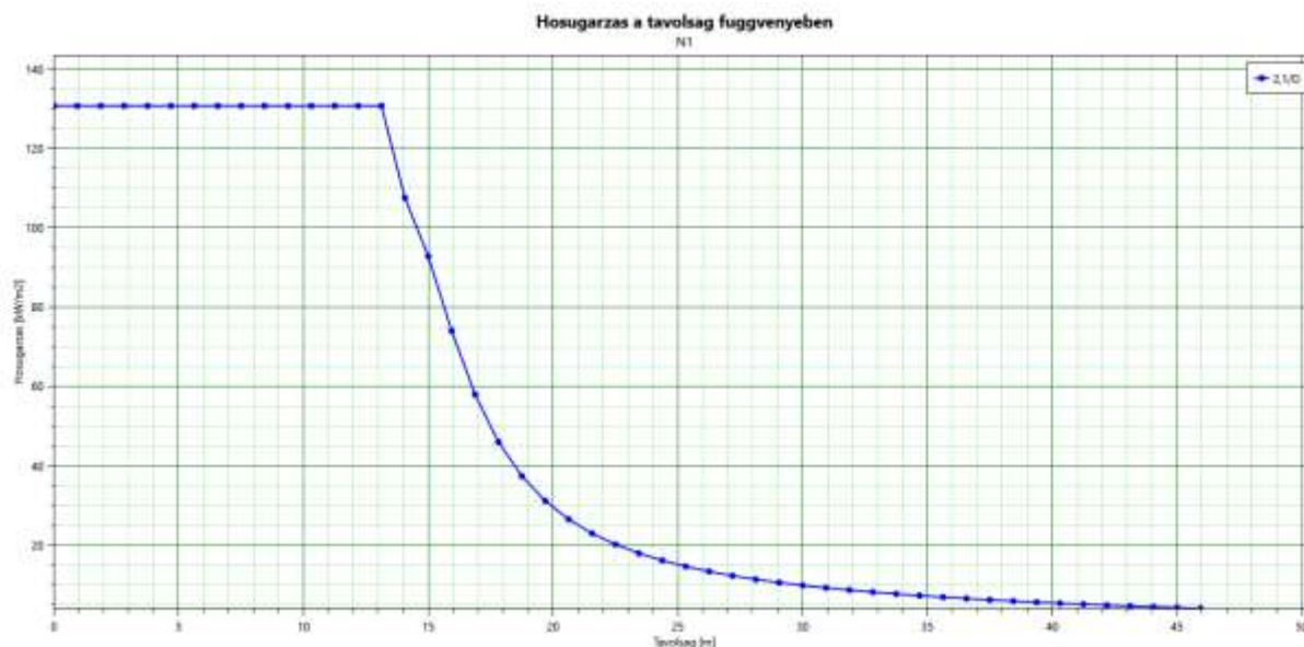
N1.1. ábra: TIT_N1_Gőz+Tócsa(Hőszugárzás vs. távolság - Tócsatűz)
