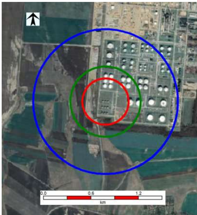
6.3.5.1.4.1.1. ábra A1 eseménysor Tűzgolyó - hőszugárzás
