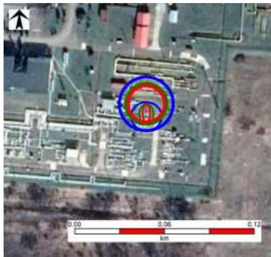
6.3.5.15.2.1.2. ábra O1 - Jettűz – hőszugárzás
